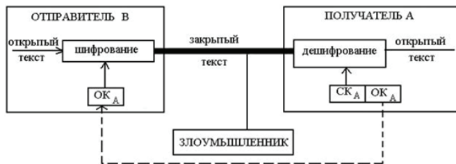
Рис. 2. Схема работы асимметричных криптосистем
