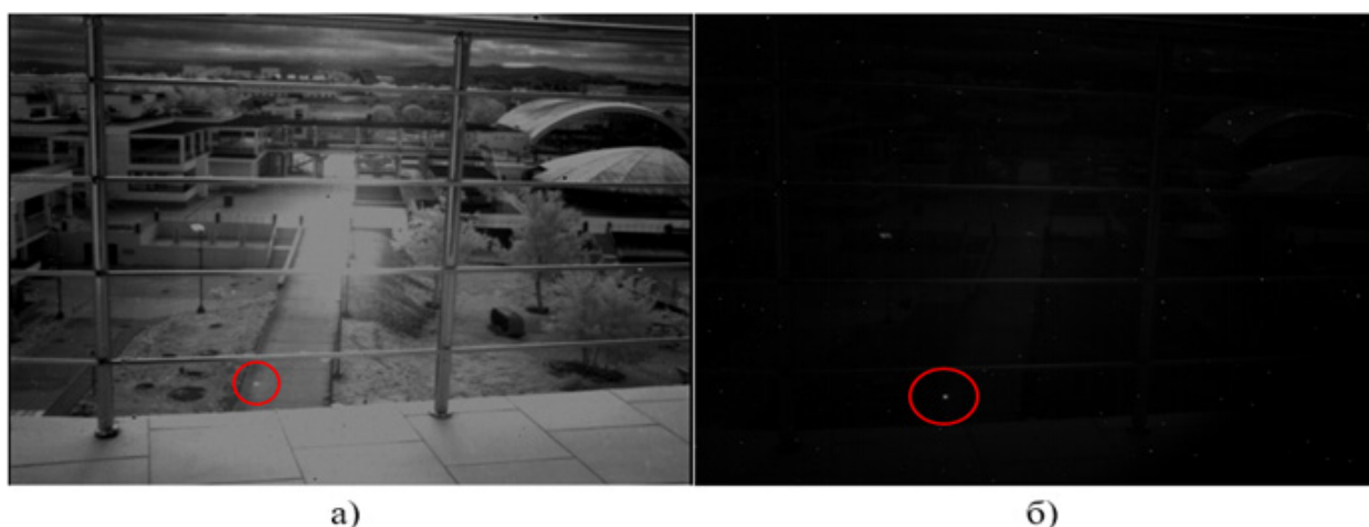
а) Без фильтра, б) Фильтр. Рис. 6. Изображение днем с SWIR камеры ОРИОН SVU0000:
