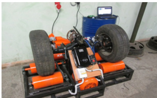
Рис. 3. Экспериментальная установка для проведения лабораторных испытаний тормозных механизмов
