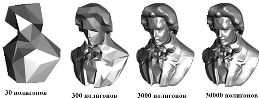
Рис. 1. Зависимость качества модели от ее детализации
