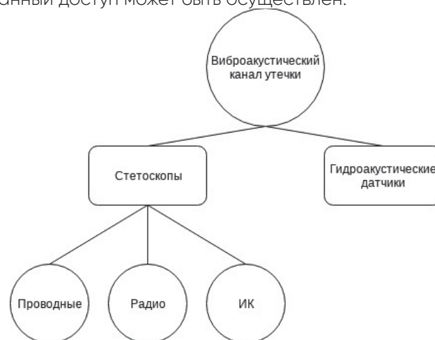
Рисунок 3. Виброакустический канал утечки
