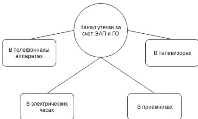
Рисунок 4. Каналы утечки за счет ЭАП и ГО
