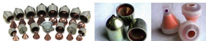
Рис. 1. Облицовки различных типов пиропатронов
