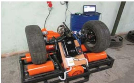
Рис. 3. Экспериментальная установка для проведения лабораторных испытаний тормозных механизмов
