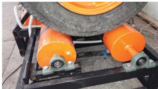
Рис. 5. Расположение датчиков сопротивления на экспериментальной установке
