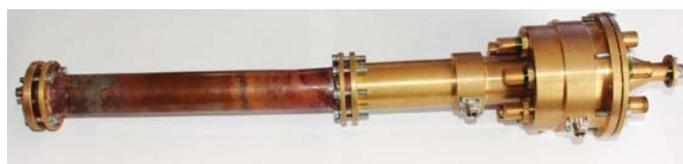
**Рис. 4.** Внешний вид формирователя СВЧ-импульсов наносекундной длительности для нелинейного радиолокатора
