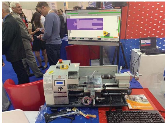
**Рис. 5 Настольный токарный станок 'ActivVision Токарный'**
