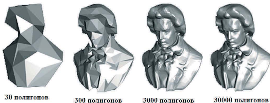
Рис. 1. Зависимость качества модели от ее детализации
