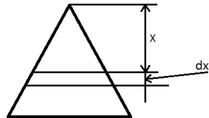
Вес кругового конуса, радиус основания которого  $r$ , а высота  $X$ , равен величине  $\frac{\pi r^2}{3} x \gamma$  (объем на плотность). Напряжение силы  $\gamma$  в этом поперечном сечении равно
